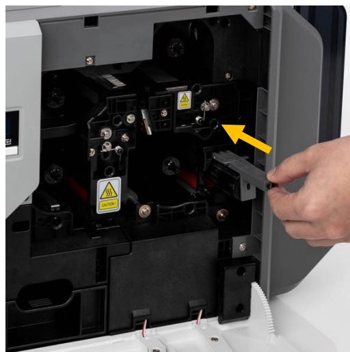
Рис. Установка картриджа с чистящим роликом
