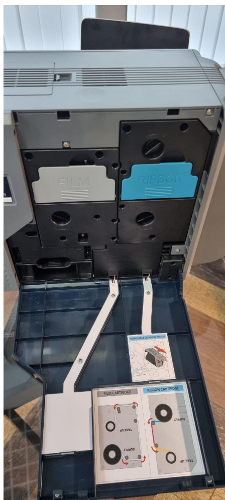
Рис. Установка модуля (IC, RF)
