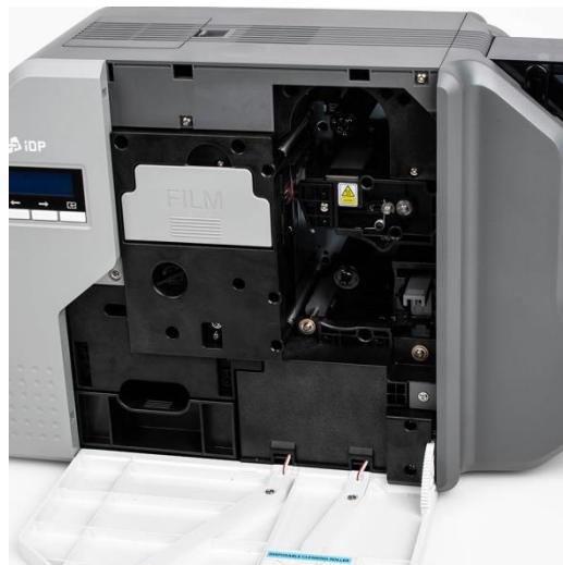
Рис. Установка картриджа с пленкой
