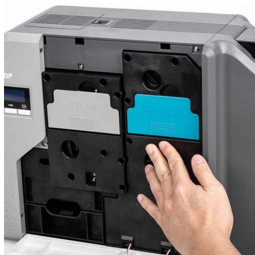
Рис. Установка картриджа с Лентой
