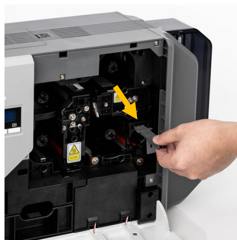
Рис. Вытащите картридж с чистящим роликом
