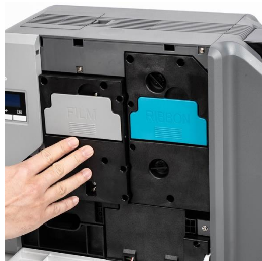
Рис. Установка картриджа с Пленкой
