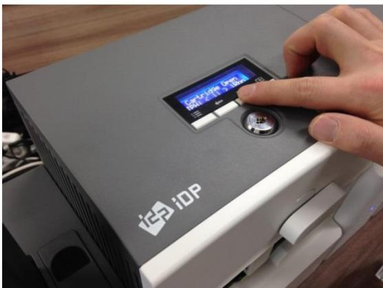
Рис. 120 Блокировка карты в Ламинаторе
