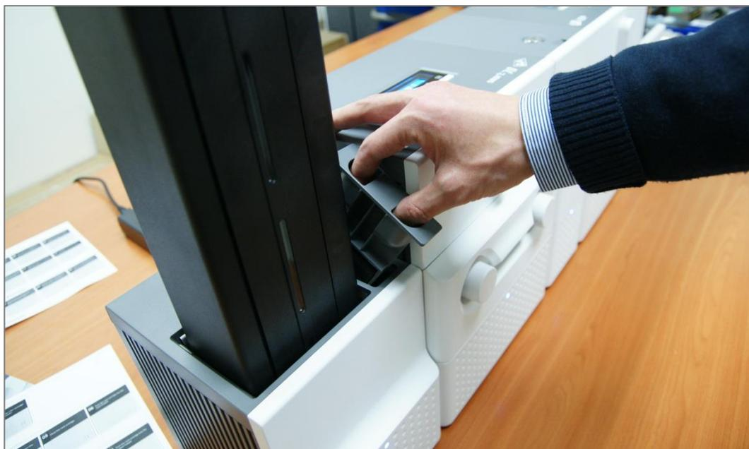
Рис. 27 Отсоединение держателя чистящего одноразового ролика.
