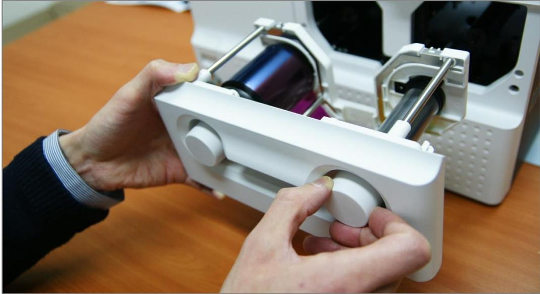
Рис. 24 Печатная лента / ламинирующая лента – установка
