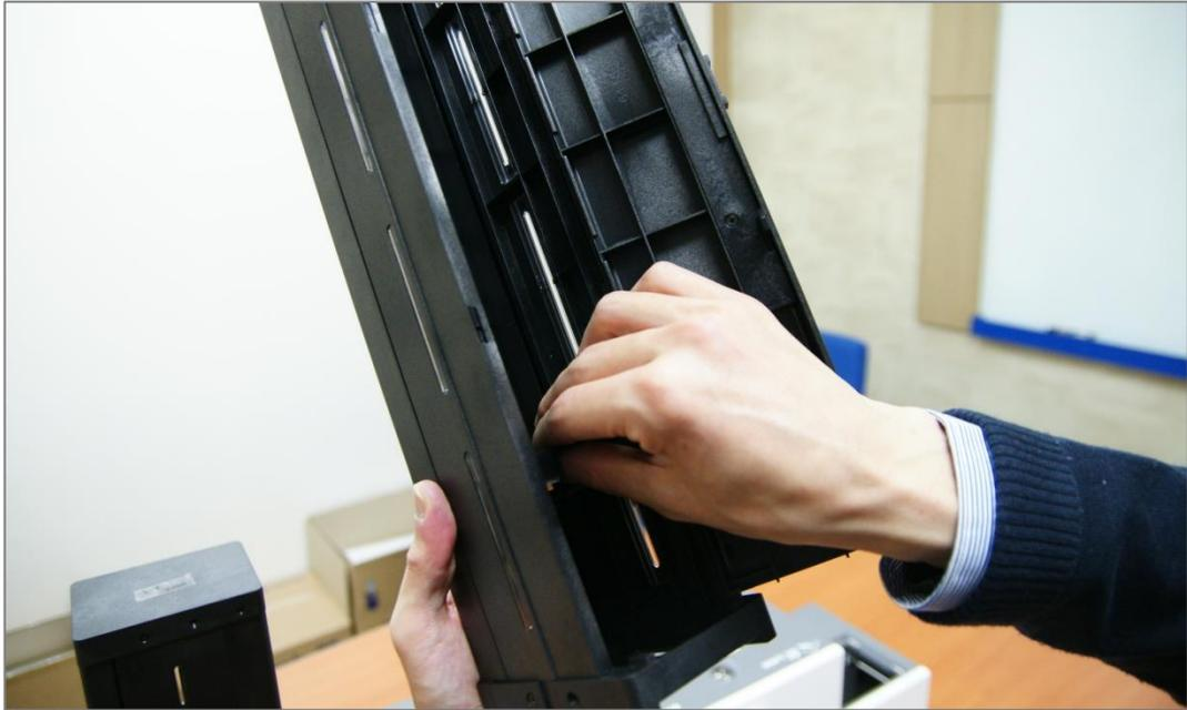
Рис. 36 Фиксация «планки» картриджа для карт
