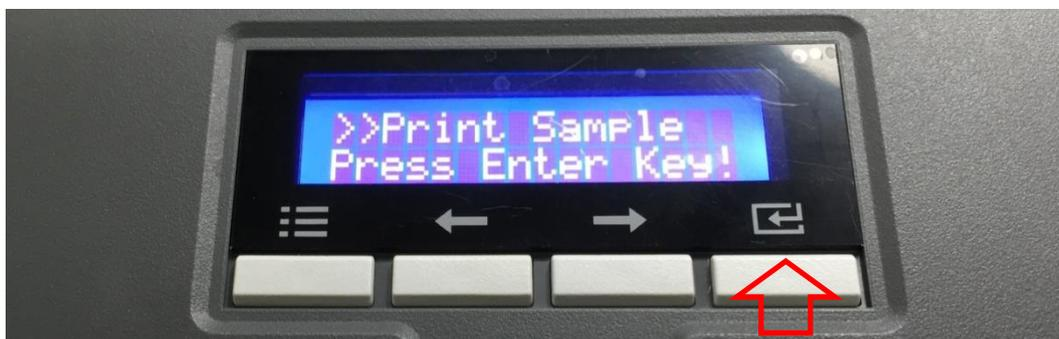
Рис. 53 Меню принтера – «Распечатать образец» (Print Sample)
