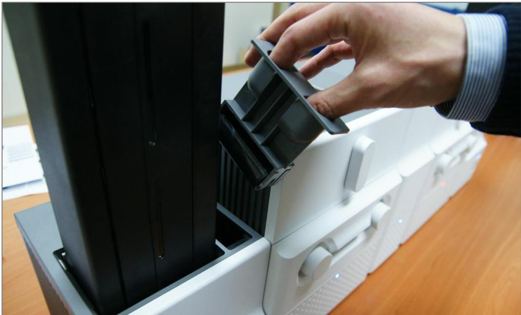
Рис. 31 Установка держателя с чистящим роликом
