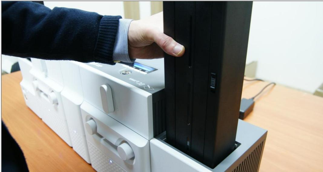
Рис. 40 Загрузка картриджа в модуль выдачи карт
