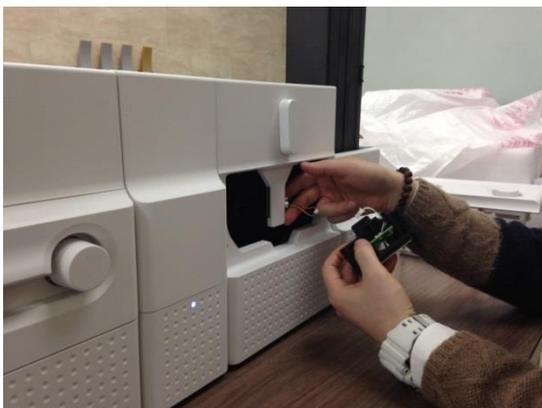
Рис. 151 Замена головки Ламинатора
