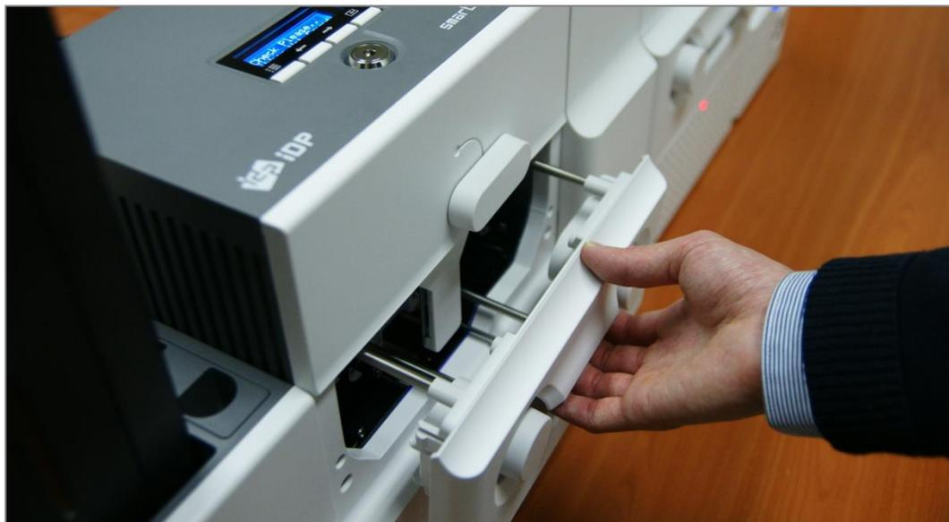
Рис. 20 Вынимание картриджа с печатной / ламинирующей лентой
