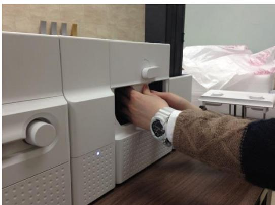
Рис. 152 Замена головки Ламинатора
