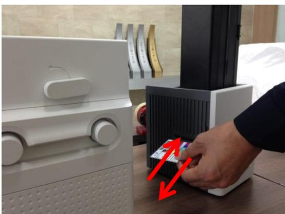
Рис. 124 Блокировка карты в Выходном лотке
