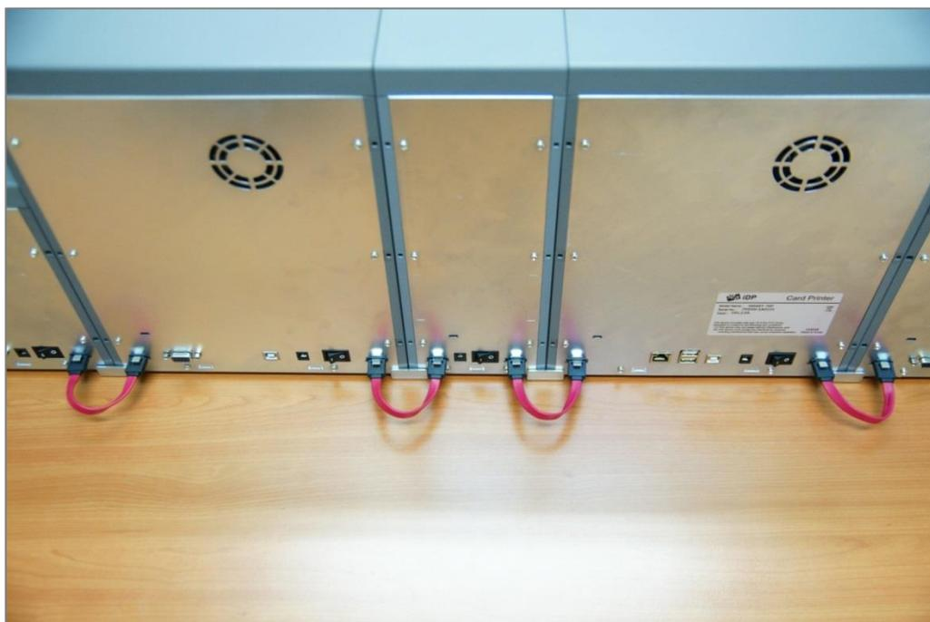
Рис. 17 Подключение модулей
