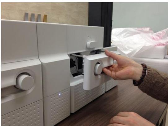
Рис. 148 Замена головки Ламинатора
