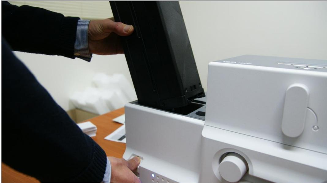
Рис. 32 Изъятие картриджа из модуля Входного модуля картриджа карт
