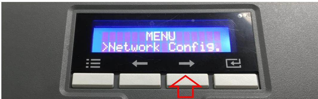
Рис. 50 Меню принтера (Network Config)
