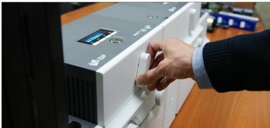
Рис. 26 Закрытие картриджа с Печатной / Ламинирующей лентой
