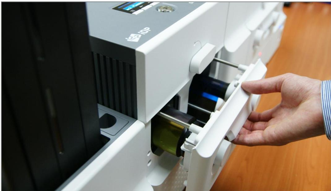
Рис. 25 Установка картриджа с Печатной или Ламинирующей лентой
