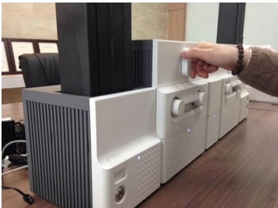
Рис. 108 Блокировка карт в Принтере
