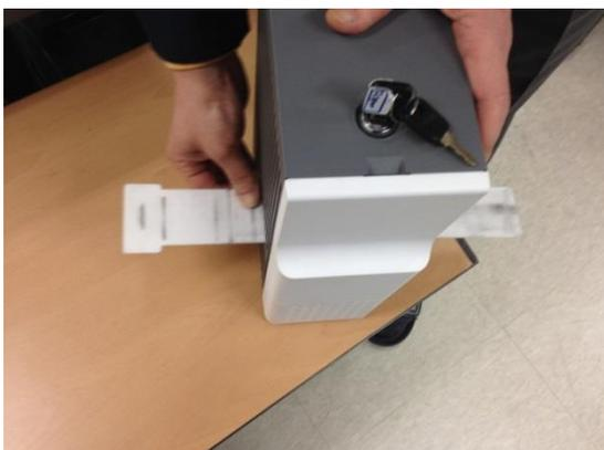
Рис. 134 Очистка Гибридного флиппера
