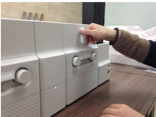
Рис. 117 Блокировка карты в Ламинаторе
