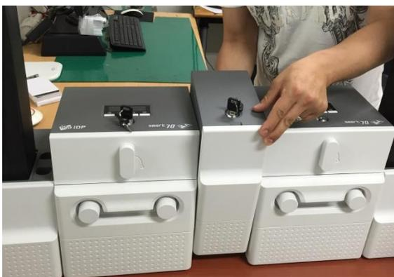
Рис. 133 Очистка Гибридного флиппера
