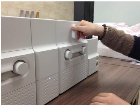
Рис. 147 Замена головки Ламинатора
