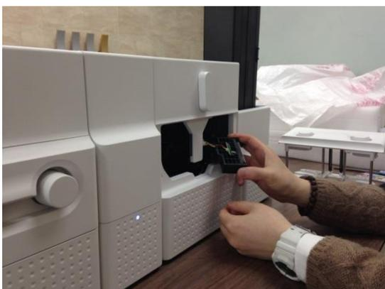
Рис. 150 Замена головки Ламинатора
