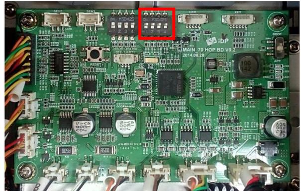
Рис. 55 Расположение DIP переключателя модуля ADVENT SOLID-700
