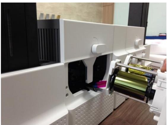
Рис. 110 Блокировка карт в Принтере
