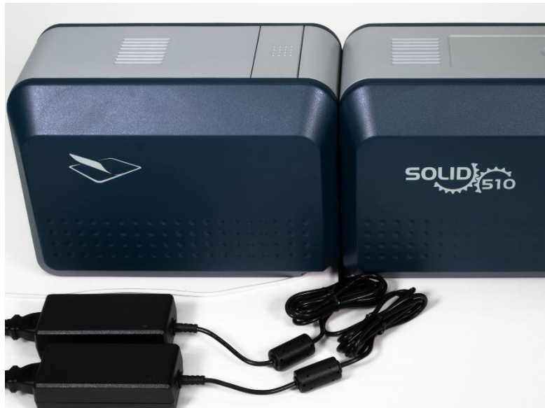
Рис. 12 SOLID-510L Коннект обоих кабелей питания и USB-провода
