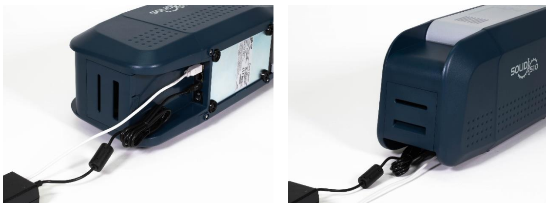
Рис. 10 SOLID-510D Коннект кабеля питания и USB кабеля
