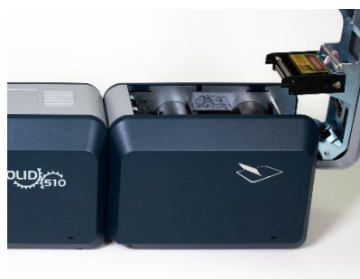
Рис. 23 Установка пленки ламинатора
