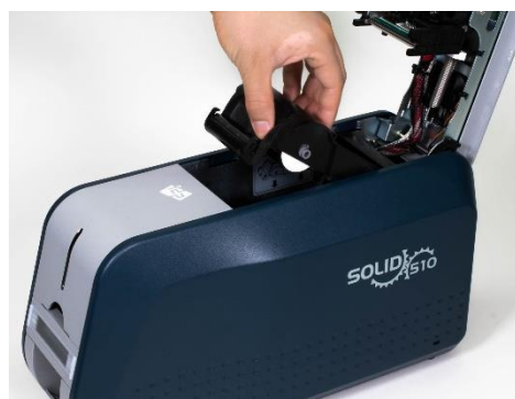
Рис. 19 Установка съемного картриджа с лентой
