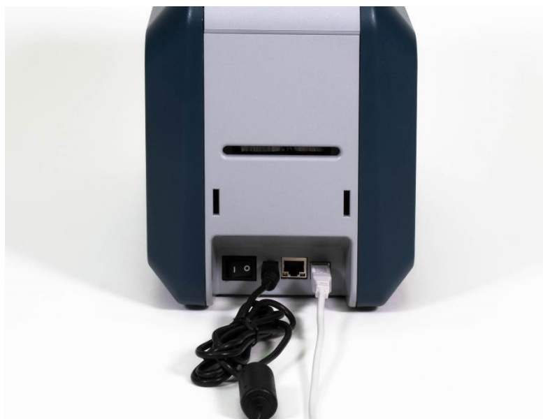
Рис. 9 SOLID-510S Коннект кабеля питания и USB кабеля
