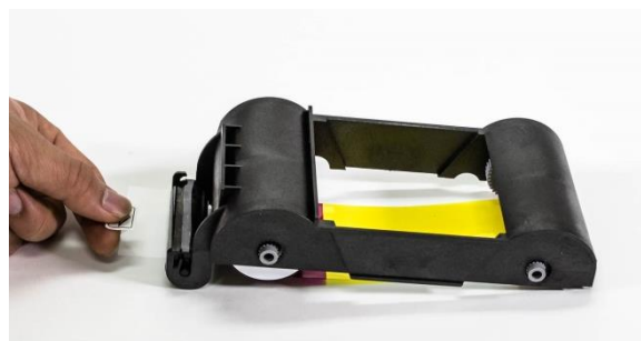
Рис. 18 Удаление защитной ленты
