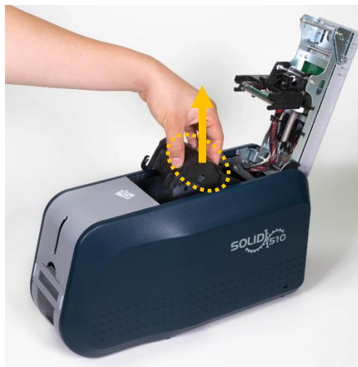
Рис. 14 Изъятие картриджа с печатной лентой
