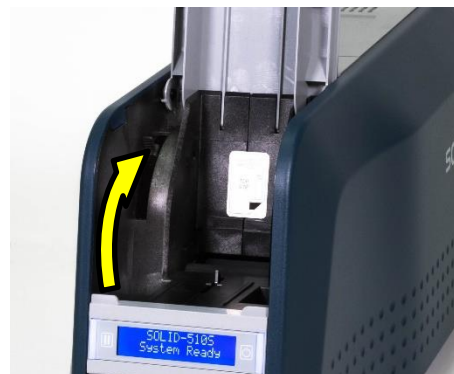
Рис. 24 Механизм настройки толщины карт
