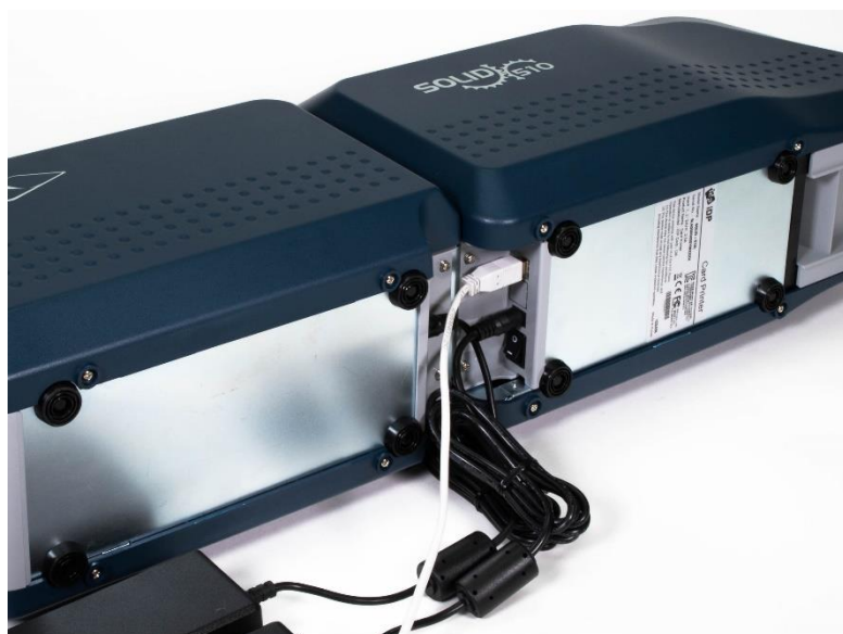
Рис. 11 SOLID-510L Коннект обоих кабелей питания и USB-провода
