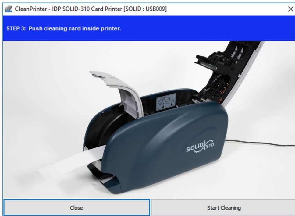
Рис. 90 Очистка Принтера Шаг 3
