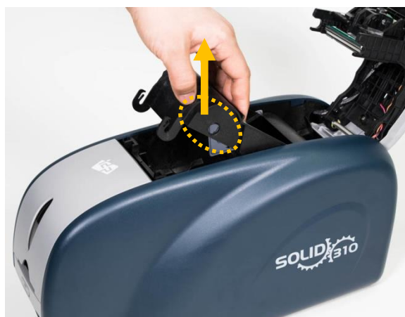
Рис. 9 Вытащите съемный картридж с лентой
