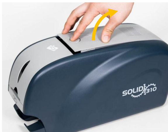
Рис. 8 Откройте верхнюю крышку
