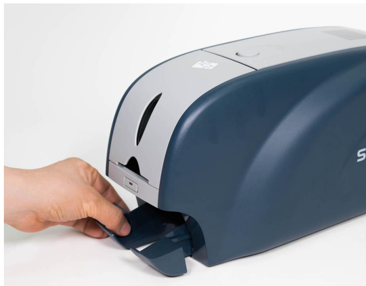
Рис. 24 ADVENT SOLID-310 «Разделение» лотка выдачи карт
