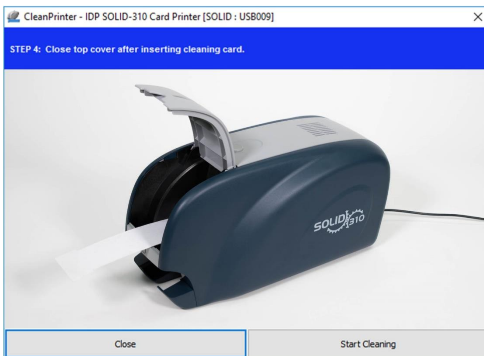
Рис. 91 Очистка Принтера Шаг 4
