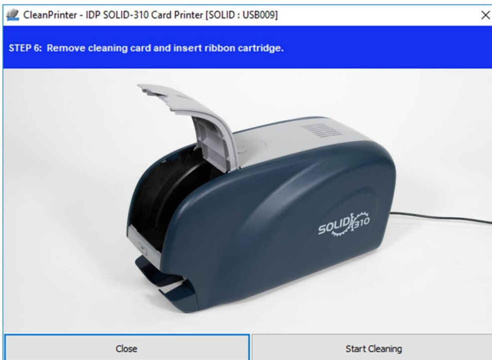
Рис. 93 Очистка Принтера Шаг 6
