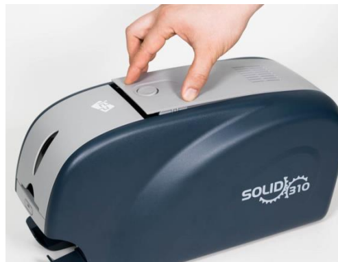
Рис. 15 Закройте верхнюю крышку
